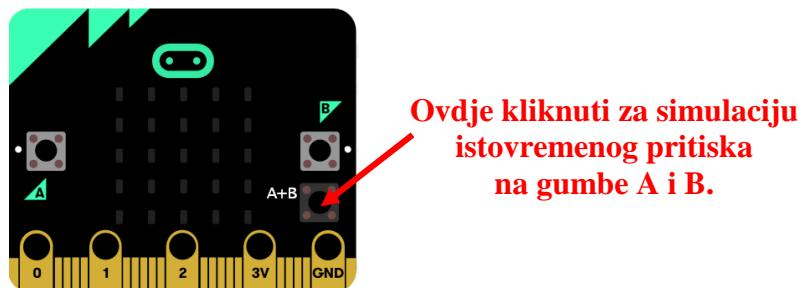
Također, pri programiranju se može namjestiti da se pri trešenju micro:bita izvrše određene naredbe. Ako je takva mogućnost u programu predviđena, u simulatoru uz taj program, pojavljuje se i polje na koje možemo kliknuti i efekt će biti kao kad pravi micro:bit protresememo.
