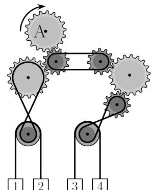
16. [Kina] Zupčanik označen s A okreće se u smjeru kazaljke na satu, kao što je prikazano na slici. Koje će se dvije kutije pomaknuti prema gore?
